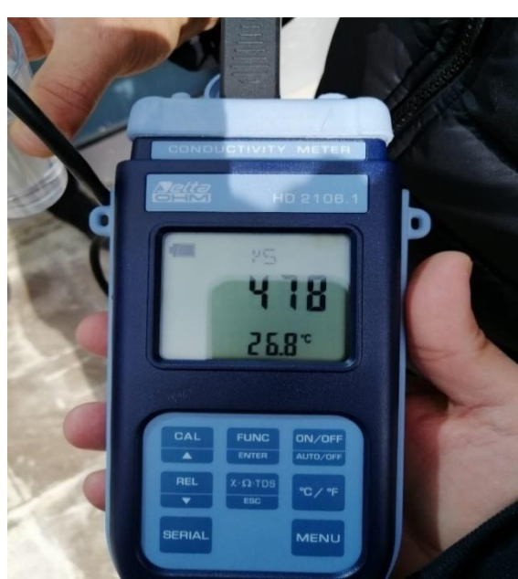
Şekil 12. Isı merkezi besi suyu iletkenlik deęeri
