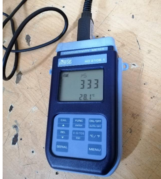
Şekil 13. Havuz kazan suyu iletkenlik deęeri
